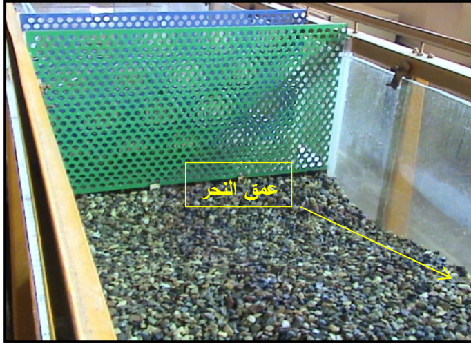
الشكل (1): المخطط التركيبي للقناة وموقع الجدار المنخلي والهدار في القناة
